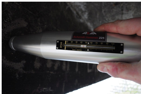
Rys. 7.2. Badanie sklerometryczne betonu
