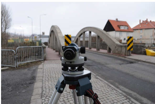
Rys. 7.1. Pomiary niwelacyjne mostu
